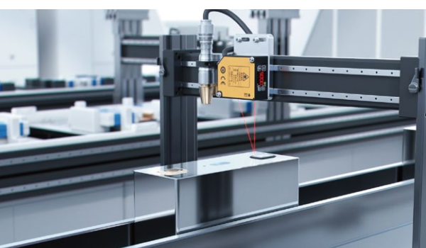
頂蓋焊接離焦量檢測
